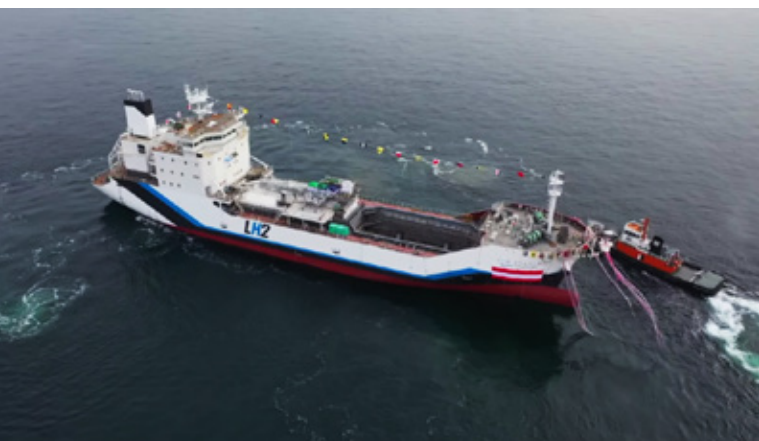
Фигура 2. Корабът „Suiso Frontier“ за транспортиране на 1250 куб.м. втечен и свръх-охладен водород. Въведено от Kawazaki Heavy Industries.
